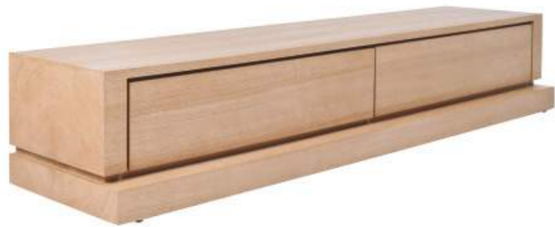
电视柜 A E1 级 MDF 贴橡木木皮、 blum 导轨 1800 X 440 X 304
